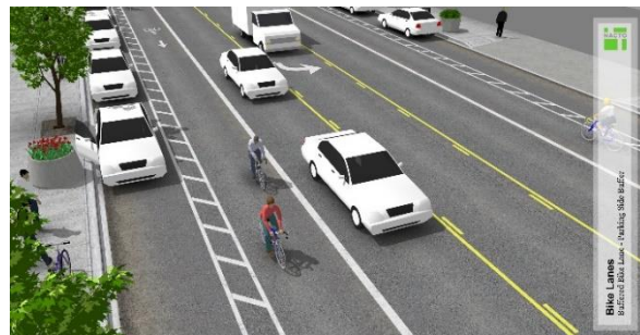
Figure 3. Design de zone tampon pour une bande cyclable (NACTO, 2018)
